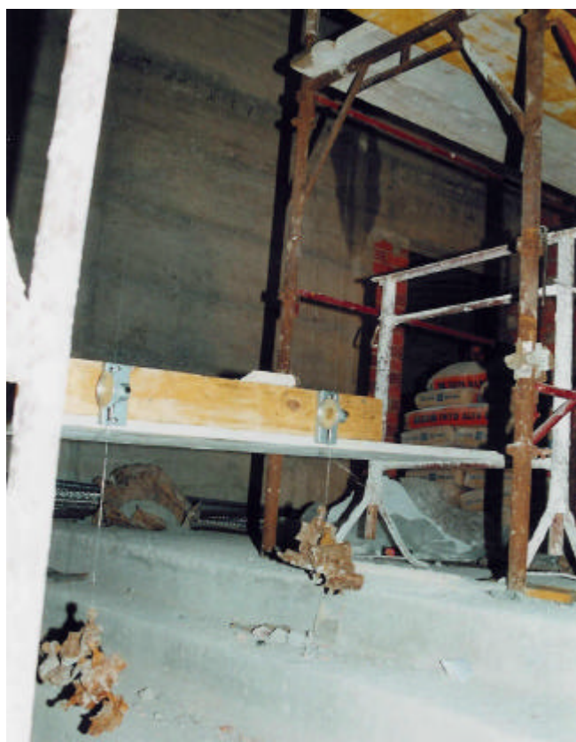
Figura 4: Flessimetri centesimali, cavetti d'acciaio e contrappesi
